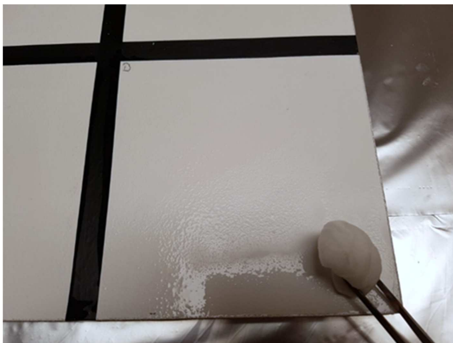
Abb. 6: Bestreichen des Prüffeldes „D“
